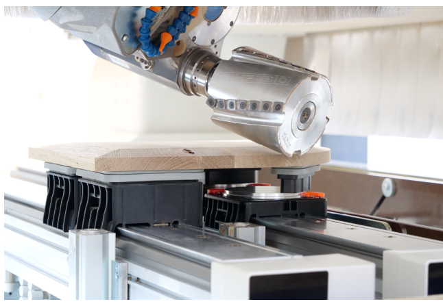
Blocksauger VCBL-S6 beim Einsatz auf SCM-Konsolen
